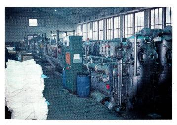
Die Veredlung umfasst HT-Jet und Breitfärbemaschinen sowie Haspelkufen und Sternfärbeapparate. Sie ist eingerichtet für ein Produktionssortiment von Geweben in verschiedensten Gewichtsklassen, Materialzusammensetzungen und Konstruktionen.
