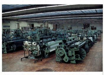
Websaal mit 42 Sulzer-Webmaschinen, vierfarbig mit Vorspulgerät, Namenleisten- und Schaftmaschinen
