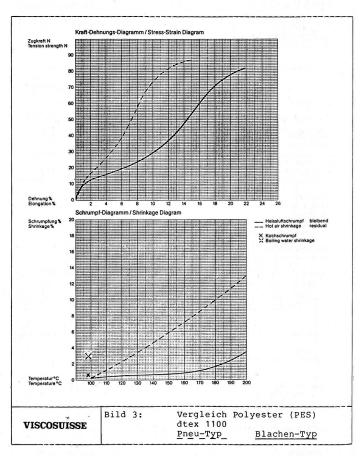
Bild 3 zeigt, dass sich die für Reifeneinlagen beziehungsweise Beschichtungs- und Gummierungsgewebe geeigneten Garne im Kraft-Dehnungs-Diagramm und dem Schrumpf-Diagramm recht deutlich unterscheiden.
