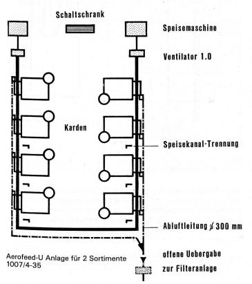
Die Produktionssteuerung der Speisemaschine (Ein/Aus) geschieht mit einem Differenzdruckschalter, der vor dem ersten angespiesenen Schacht an den Speisekanal angeschlossen ist.
