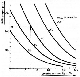
Bild 2 Prüfleistung bei Einspannlänge 500 mm
