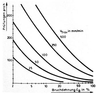
Bild 1 Prüfleistung bei Einspannlänge 250 mm
