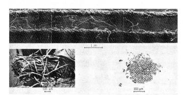
Abb. 2 REM-Aufnahmen und lichtmikroskopische Querschnittaufnahmen eines OE-Friktionsspinngarns (DREF) 50 tex, 60% Kern (PES)/40% Mantel (Baumwolle)
