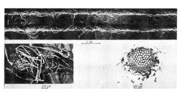
Abb. 3 REM-Aufnahmen und lichtmikroskopische Querschnittaufnahme eines OE-Friktionsspinngarns (DREF) 55 tex, Filament (180 dtex)/Baumwolle
