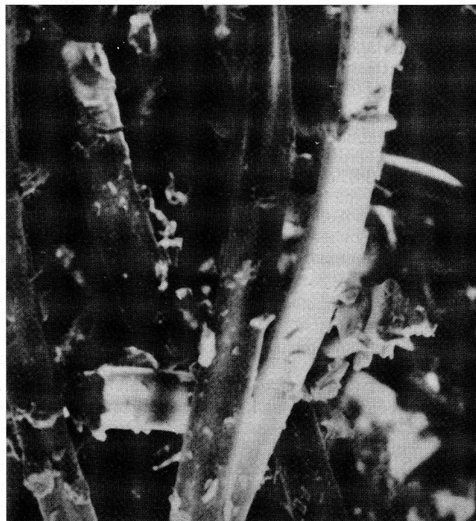
Teppichfasern unter dem Mikroskop: an unbehandelten Teppichfasern klebt der Schmutz und ist schwierig zu entfernen.
