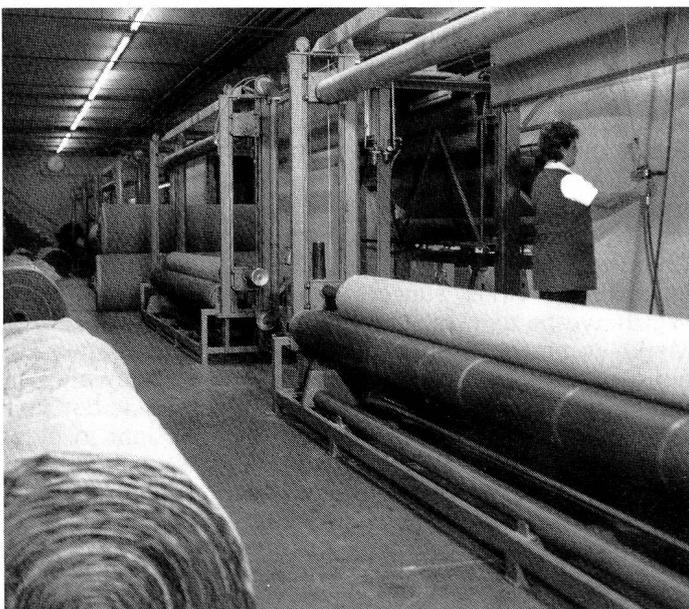
Das Weben ist eine jahrtausendealte Technik, die sich allerdings ständig verfeinert hat, und die Webmaschinen sind bis fünf Meter breit geworden. Der eigentliche Webvorgang ist indessen der gleiche geblieben: die in der Länge verlaufenden Kettfäden werden mit den quer eingetragenen Schussfäden verkreuzt oder verflochten.
