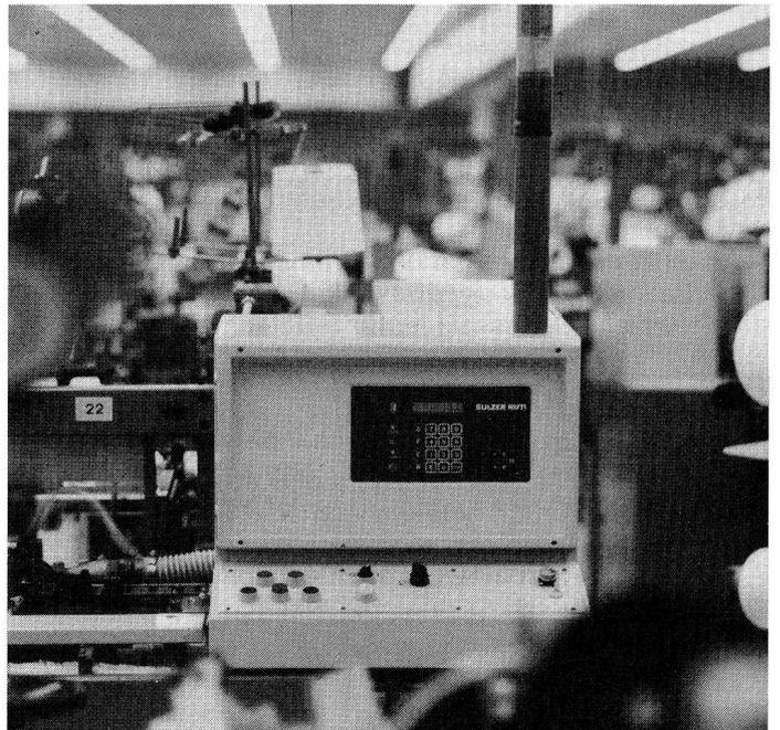
Herzstück der Webmaschinenüberwachung und -steuerung: der Mikroprozessor
