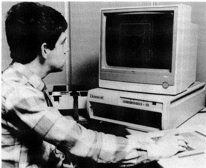
Zwei englische Unternehmen – Terminal Display Systems (Blackburn) und CAD/CAM Punch (Nottingham) – haben gemeinsam unter dem Namen Easypunch ein System entwickelt, das Stickmuster anlegen und sie direkt in Lochstreifen für die Maschinensteuerung umsetzen kann.
