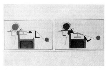
Bei Wiedereinschalten fährt die Maschine nach Schliessen der Schutzhaube automatisch auf die vorgewählte Produktionsgeschwindigkeit.
