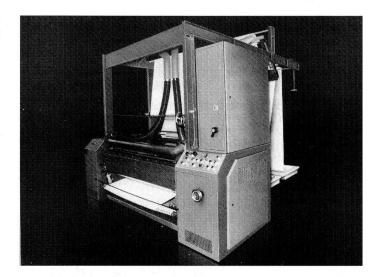
jede warenbedingte Position zum Schneidtisch eingestellt werden. Beim Anlaufen bzw. Abbremsen der Messerwelle, verhindert eine patentierte Abhebeeinrichtung die sonst so gefürchteten Grundanschnitte.
