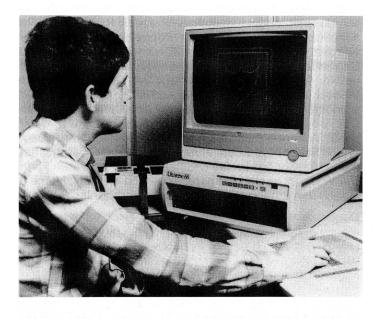
Zwei englische Unternehmen – Terminal Display Systems (Blackburn) und CAD/CAM Punch (Nottingham) – haben gemeinsam unter dem Namen Easypunch ein System entwickelt, das Stickmuster anlegen und sie direkt in Lochstreifen für die Maschinensteuerung umsetzen kann
