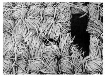
Bild 6 Durch Einpressen einer Stecknadel verletztes Baumwollgewebe Vergrösserung: 50  $\times$
