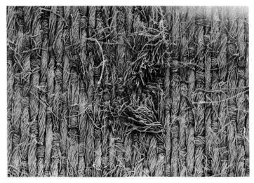
Bild 1 Schnittartige Verletzung Vergrösserung: 24 ×
