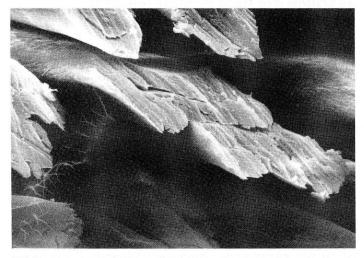
Bild 2 Defekte Baumwollfaserenden mit «Schnittrillen» Vergrösserung: 2000 ×
