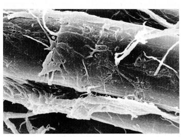
Bild 10 Scheuerschaden an Leinenfasern Vergrösserung: 2000 ×
