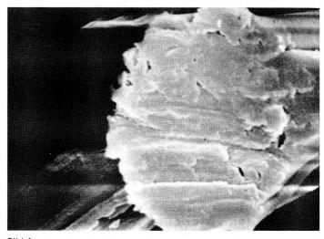
Bild 4 Defektes Viskosefaserende mit «Schnittrillen» Vergrösserung: 4000 ×
