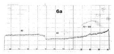
No. 6a Sulzer Webmaschine. Schurwolle. Einzel-Kettfaden. Der Einfluss des Schusses ist deutlich sichtbar.
