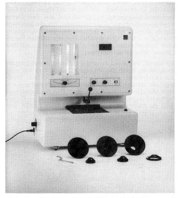
Textest FX 3030 Luftdurchlässigkeits-Prüfgerät
