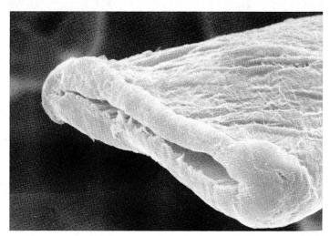
Bild 5 Baumwollfaserende, welches nach der Verletzung alkalisch gewaschen wurde Vergrösserung:  $4000 \times$
