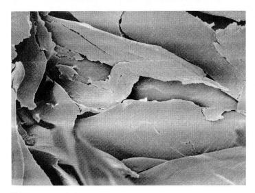
Bild 7 Verquetschte Baumwollfasern der Schadenstelle von Bild Nr. 6 Vergrösserung: 750  $\times$
