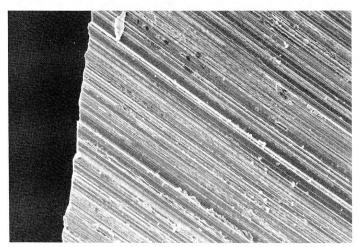
Bild 3 Messerschneide Vergrösserung: 2000 ×
