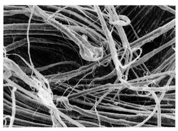
Bild 9 Scheuerschaden an Leinenfasern Vergrösserung: 200 ×
