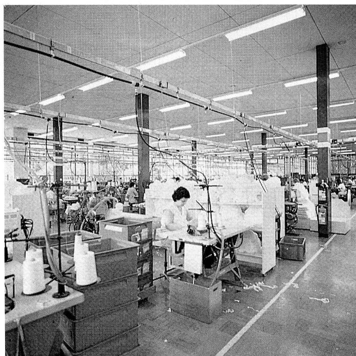
Moderne Lichtleisten mit Reflektoren an Montageschienen bieten einen zeitgemässen Beleuchtungskomfort in der Näherei der Firma Sidema SA in Lugano und ermöglichen gleichzeitig eine Reduktion des Energieverbrauchs auf weniger als die Hälfte.
