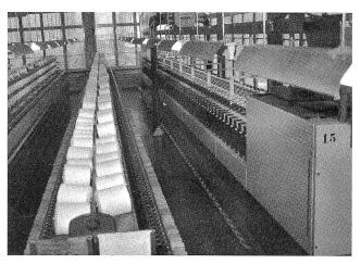
Rechts im Bild die DD-Saurer-Alma-Zwirnmaschine für Popelinezwirne Ne 60/2 bis Ne 100/2; links Rieter-Ringzwirnmaschinen speziell für Voilezwirne und ganz feine Popelinezwirne Ne 100/2 bis Ne 160/2
