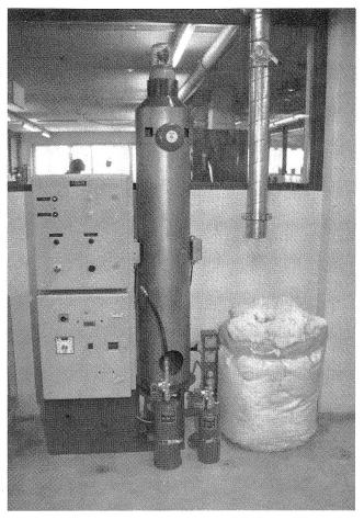
Testgerät zur Bestimmung der Leistungscharakteristika der Infrarotdetektoren
