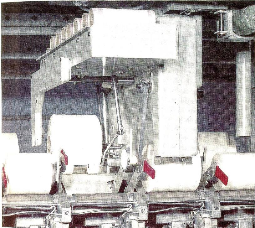
Ein bewährtes System: Starter-Spulmaschine und Kreuzspulenwechsler.
