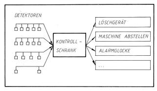
Aufbau eines Brandschutzsystems
