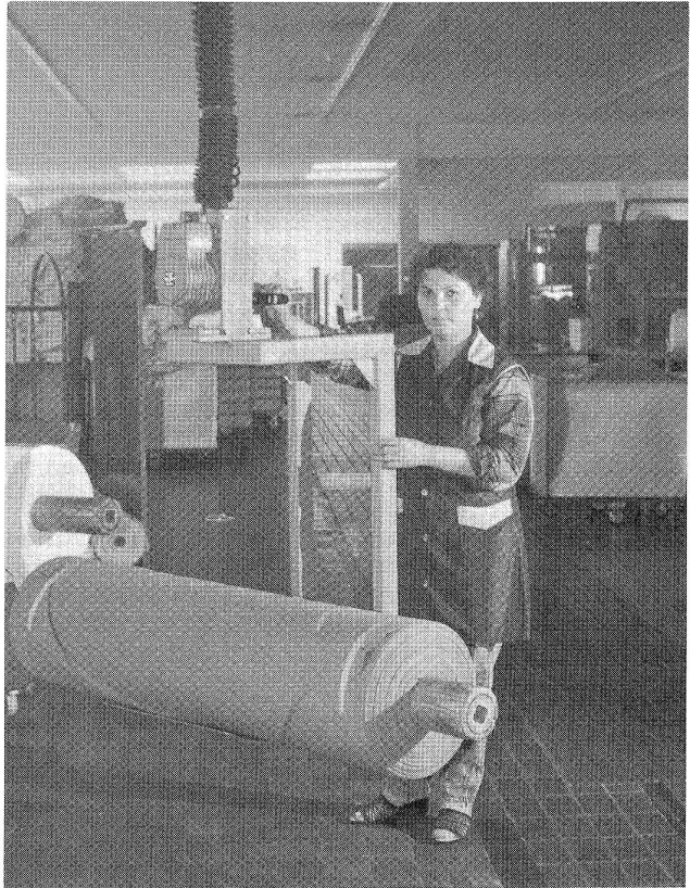
Die 250 kg schweren Stoffrollen werden von der Bedienungsperson mit einer Hand spielend leicht manipuliert
