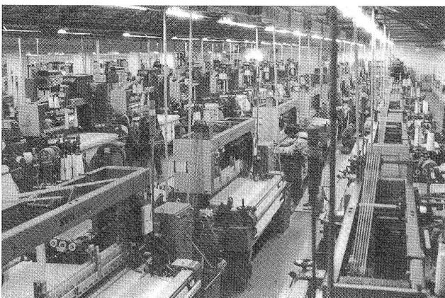
Websaal mit Rueti-Luftdüsenwebmaschinen T-strake
