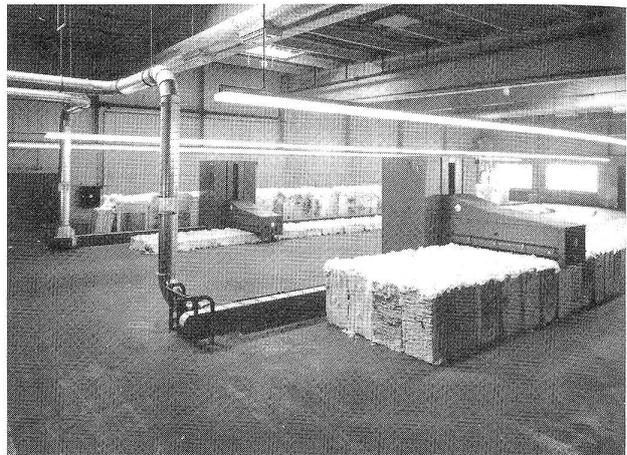
Automatische Ballenabtragmaschinen Unifloc A1/2-2000. Das verlängerte Abtragorgan erlaubt eine Produktion bis zu 1000 kg/h beim gleichen Sortiment.
