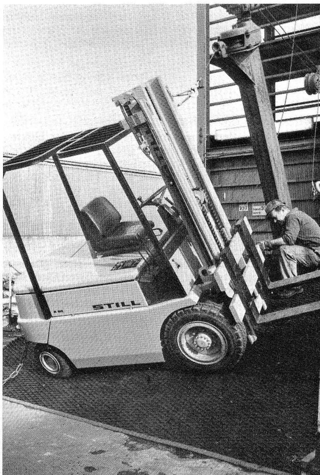
Wenn ein Gabelstapler im Versuch 4 bei solch einer Neigung der Testplattform noch alle vier Räder auf dem Boden hat, kann sich der Fahrer mit Recht sicher fühlen.
