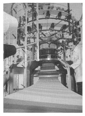
Dieser Versanit APC Striper ist eine Strickmaschine für einfache Trikot- und gestreifte Jacquardgewebe, bei der die Umstellung von Muster auf Muster nur wenige Minuten und nicht mehrere Stunden erfordert und die so programmiert werden kann, dass von Jacquard (einem komplizierten Verfahren, nach dem sich praktisch jedes Muster erzielen lässt) auf die Fertigung glatter oder gestreifter Ware geschaltet werden kann.
