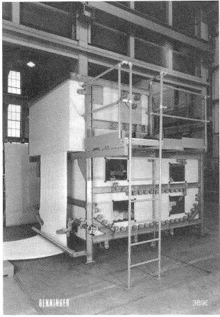
Kaltverweilaggregat Modell AB für Na-Hypochlorit
