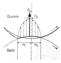
Presszone (Nip): Verformung und Druckverteilung (im Lauf Verschiebung der geometrischen Mitte um  $\rm n_o$  zur Einlaufseite).
