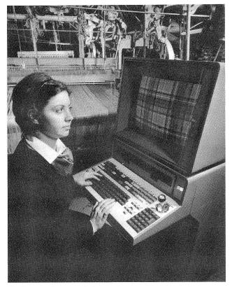
Die Komplexität des auf diesem Computerterminal gezeigten buntkarierten Schottenstoffes ist ein Beispiel für die vielfältige Verwendbarkeit des neuen Webarten-Simulationsprogrammes, das es den Textildesignern ermöglicht genau vorherzusagen, wie ein neues Muster aussehen wird.
