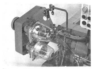
Abb. 8 Rotationsspeicher zur Verarbeitung von Glasgarnen.
