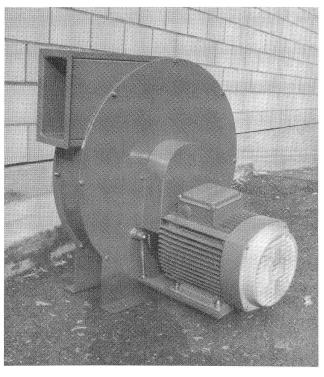
Abb. 5 Riemengetriebener Spezial-Transportventilator zur Abreinigung des Filtermediums
