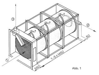
Automatische Trommelfilter dienen der Entstaubung grosser Luftmengen, z.B. in der Spinnerei, Weberei, Textilausrüstung, Papier- und Tabakindustrie oder ähnlichen Einsatzfällen. Dazu wurde bisher die staubhaltige Luft von aussen nach durch die rotierende Filtertrommel gesaugt.
