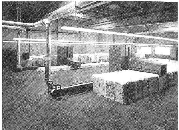
Automatische Ballenabtragmaschinen Unifloc A1/2-2000. Das verlängerte Abtragorgan erlaubt eine Produktion bis zu 1000 kg/h beim gleichen Sortiment. Bild: Rieter AG
