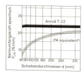
Zugschichten aus Polyamid (PA) ermöglichen die vom Scheibendurchmesser weitgehend unabhängige Leistungsübertragung pro mm Riemen-
