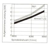
Modernste Werkstoffe und der spezielle Aufbau der neuen Armid-Tangentialriemen vermindern die Eigenenergieaufnahme des Riemens wesentlich. Gemäss Messungen eines Instituts für Textiltechnik konnte auf einer Ringspinnmaschine eine Reduktion der aufgenommenen Leistung, d.h. eine Senkung der Energiekosten um 14-18% beobachtet werden (möglicher Messfehler ± 4%).
