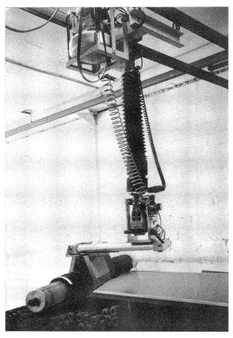
Rollengreifer für Ø 100–300 mm, konzipiert für exzentrische Belastung, ausgerüstet mit pneumatischer Sicherheitsspannung. Bruno Zwahlen AG, Galgenen
