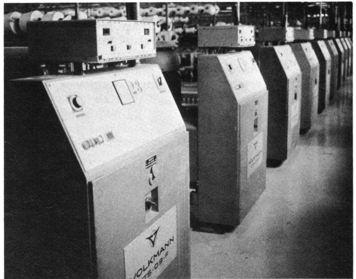
Datenerfassungsgeräte auf DD-Anlage montiert
