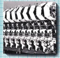
die universelle Strangspulmaschine mit Einzelantrieb und elektronisch gesteuer-Langsamanlauf, erhältlich mit Rillentrommeln oder Fadenführern
