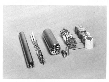
Sulzer-Mischer SMX und SMXL für Schmelzspinnanlagen. Schnittbilder entlang der Mischstrecke beim Vermischen von zwei Epoxidharzen im SMX-Mischer zeigen deutlich die rasche Zunahme der gebildeten Schichten und somit der Homogenität. (Werkfoto Sulzer)
