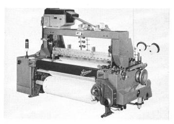
Abbildung 4: Günne-Luftdüsen-Webmaschine Air-jet 2000 für Flachgewebe
