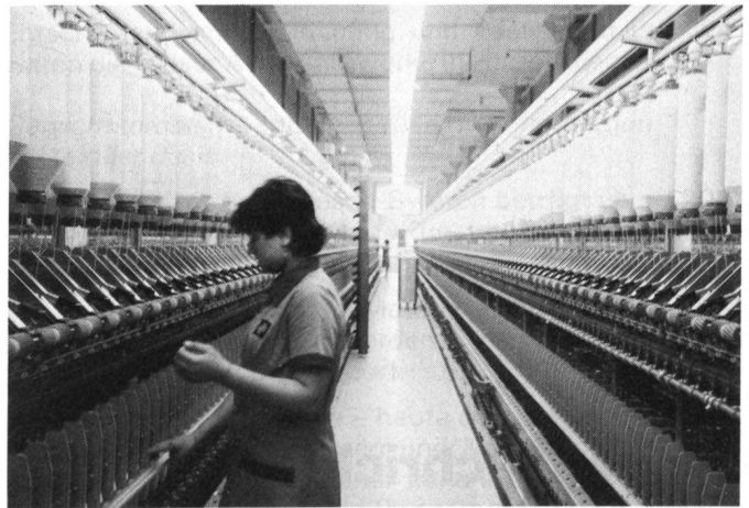
In der Ringspinnerei wird das Vorgarn (auf den Maschinen oben) durch ein Streckwerk geführt und anschliessend zum fertigen Garn gedreht. (Foto: Kurt Staub)
