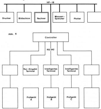
Gerät A steht stellvertretend für alle rein mechanischen Prüfapparaturen, beispielsweise Quadrantenwaagen, Drehungsprüfer, Pendelarmdynamometer o.ä., bei denen der Messwert abgelesen werden muss. Da hier mangels eines elektrischen Signals für die Messgrösse kein on-line-Betrieb mit einem Rechner möglich ist, werden der Messwert und andere die Prüfprobe und die Prüfung kennzeichnende Daten von Hand in ein «Nur-Eingabe-Terminal» eingetastet.
