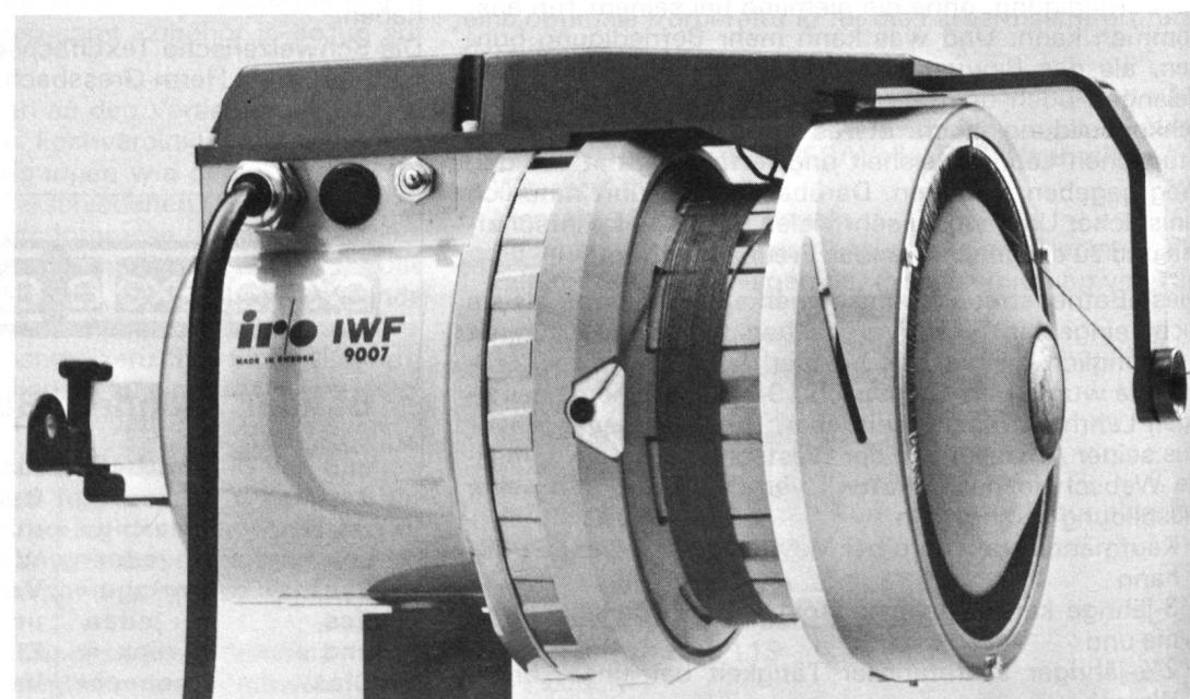
**Dank Lagenseparation für sämtliche Schussgarne, speziell auch für Haar- und Effektgarne, bestens geeignet!
