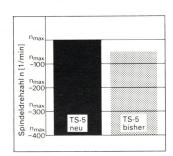
Die neu gestaltete Reibschicht des Spindelbandes TS-5 neu garantiert ein ideales Adhäsionsverhalten zwischen Antriebsscheibe/-zylinder und Spindelband. Dies ermöglicht gemäss Labormessungen höhere maximale Soindelderbanten n<sub>max</sub>.
