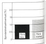
Resultate von Labormessungen zeigen, das durch das Zusammenwirken von Oberfläche eigenschaften und Elastizitätsmodul des Spindelbandes TS-5 neu auch bei gebremstet Spindeln die Drehzahl der übrigen Spindeln praktisch unverändert bleibt.
