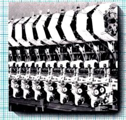
die universelle Strangspulmaschine mit Einzelantrieb und elektronisch gesteuer tem Langsamanlauf, erhältlich mit Rillentrommeln oder Fadenführern
