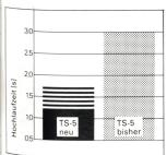
Auch ermöglichen die spezifisch auf ihre Funktion abgestimmten Reibschichten gemäss Labormessungen eine kürzere Hochlaufzeit, d.h. die volle Drehzahl der Spindeln wird nach Stillstand innerhalb kürzester Zeit erreicht.
