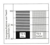
Labor- und Praxismessungen haben belegt, dass dank dem Aufbau des Habasit Spindelbandes TS-5 neu mit modernsten Werkstoffen Reduktionen der Energieaufnahme von Textilmaschinen, im Vergleich mit dem bisherigen Typ TS-5, bis zu einigen Prozenten
