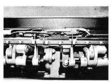
Konventionelle Greiferwebmaschinen arbeiten mit ungesteuerter Schußfadenübergabe und teilweiser Bremsenunterstützung.
