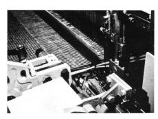
Bei konventionellen Greiferwebmaschinen wird der Schußfaden durch das sich schließende Fach ausgeschlauft. Das erhöht die Schußfadenspannung durch zusätzliche Reibung und belastet Kantenausfall und Fehlerhäufigkeit.
