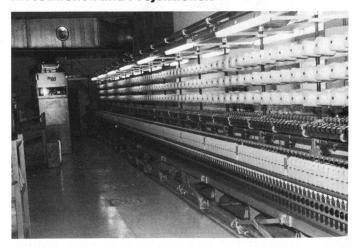
Neue Zinser-Ringzwirnmaschine mit Doffer und elektronischem Datenerfassungsgerät zur Produktionsüberwachung
