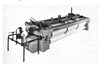
Sulzer Rüti Projektilwebmaschine des Typs PS 4000 ES E6 in niedriger Bauart mit einer max. Arbeitsbreite von 4000 mm, ausgerüstet mit Exzentermaschine
