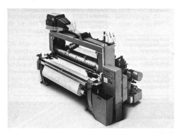
Sulzer Rüti Einfarben-Luftdüsenwebmaschine L 5000 (L1AHB190Kn) mit einer Nennbreite (max. Gewebeeinzugsbreite) von 1900 mm, ausgerüstet mit Schaftmaschine
