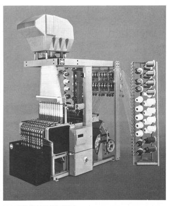
MULTICOLOR MCE 100–12/28 Etikettenwebautomat mit elektron. Jacquardmaschine EPD
