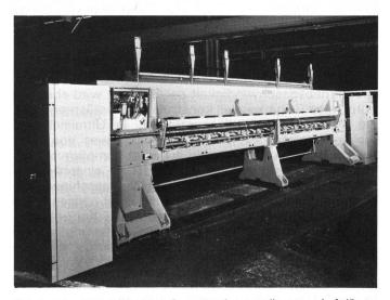
Die von der Bonas Machine Company hergestellte neue Luftdüsen-Webmaschine des Typs Superjet.
