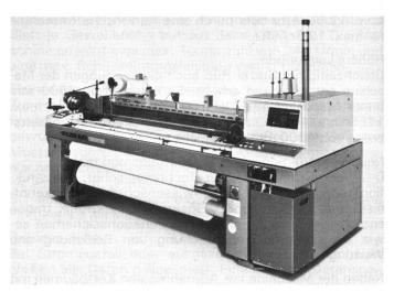
Sulzer Rüti Luftdüsenwebmaschine mit Mischwechsler des Typs L 5001 (L 1-1 TNS 1901) mit einer Nennbreite (max. Gewebeeinzugsbreite) von 1900 mm, ausgerüstet mit Innentritt und ausgestattet mit Time-Controller und Mikroprozessor.
