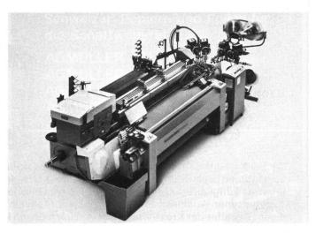
Sulzer Rüti Sechsfarben-Greiferwebmaschine F 2001 (F6 N 190 R) mit einer max. Arbeitsbreite von 1900 mm, ausgerüstet mit Schaftmaschine
