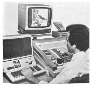
Programmieranlage System MÜCOMP II für elektronische Jacquard-Maschine FPD
