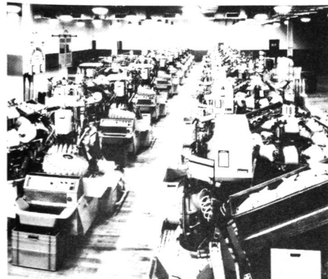
«Vollautomaten»- Anlage mit 260 Spindeln Schweiter-Coner CA 12-DV
