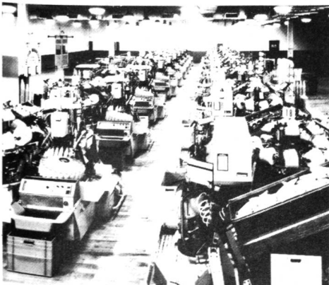
«Vollautomaten»- Anlage mit 260 Spindeln Schweiter-Coner CA 12-DV
