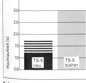
Auch ermöglichen die spezifisch auf Ihre Funktion abgestimmten Reibsichten gemäß Labormessungen eine kürzere Hochlaufzeit, d.h. die volle Drehzahl der Spindeln wird nach Stillstand innerhalb kürzester Zeit erreicht.
