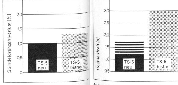
Resultate von Labormessungen zeigen, dass durch das Zusammenwirken von Oberflächen-eigenschaften und Elastizitätsmodul des Spindelbandes TS-5 neu auch bei gebremsten Spindeln die Drehzahl der übrigen Spindeln praktisch unverändert bleibt.
