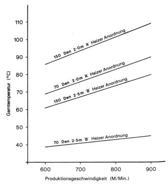
Figur 5: Fadentemperaturverhältnisse vor den Friktionsaggregaten
