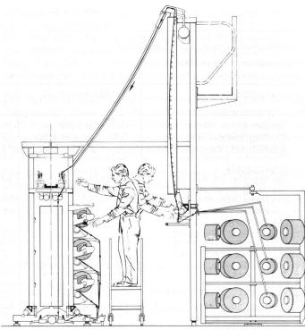
Figur 3: SDS 1100 B, Maschinenquerschnitt, Bedienbarkeit
