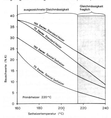
Figur 7: Bauschwerte in Abhängigkeit der Setheizertemperatur und -Konfiguration
