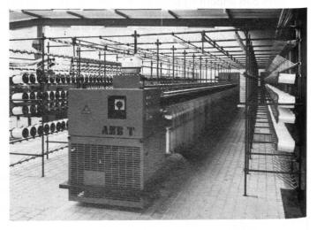
AZB-T Zwirnmaschine für technische Zwirne
