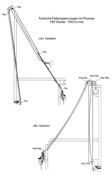
Figur 4: Heizeranordnung, Fadenspannungen am Heizer
