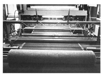
Beim Nadlieren wird das direkt ab Krempel kommende Vlies durch schnelle Bewegungen durchstochen und damit «verfilzt».
