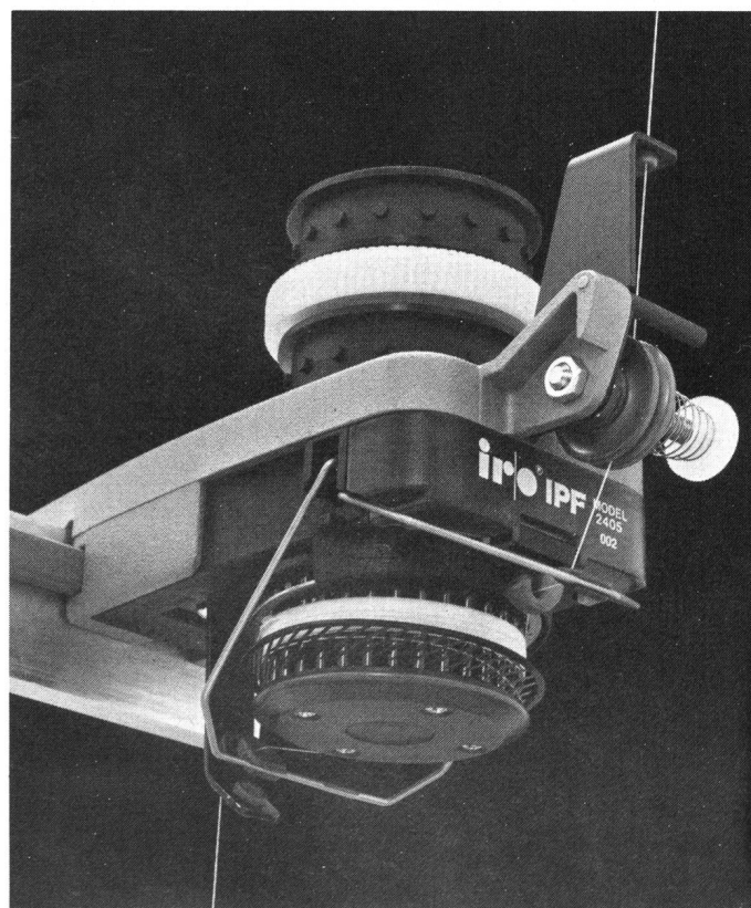
Abb. 2: Der IPF-2405-Positivfournisseur mit Zahnriemenantrieb und Fliptop.
