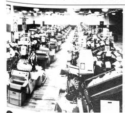
«Vollautomaten»-Anlage mit 260 Spindeln Schweiter-Coner CA 12-DV
