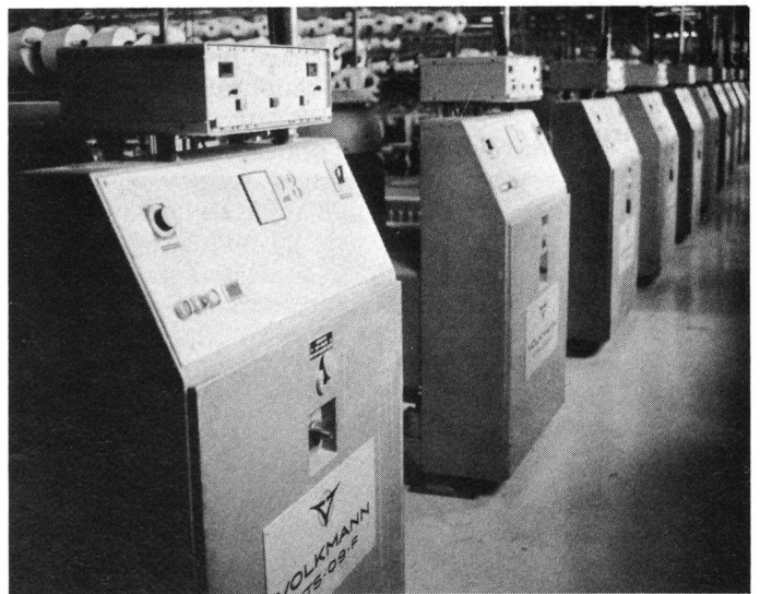
Datenerfassungsgeräte auf DD-Anlage montiert
