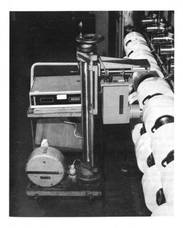
Zur genaueren Überwachung der Restfeuchte auf den an der Spinnmaschine aufgewickelten Fadenpaketen wird, wie das Bild zeigt, ein Feuchtemessgerät Modell 478-II der Firma moisture system corp. Hopkinton, Mass./USA, verwendet.
