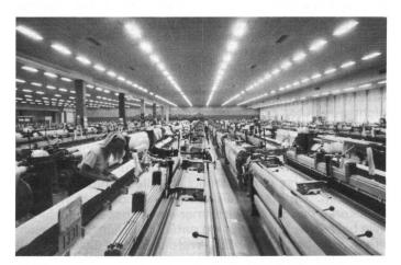
Bild 13 Moderne Webmaschinenanlage mit 192 Sulzer-Rüti-Projektilwebmaschinen
