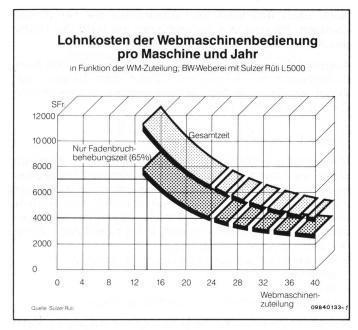
Bild 8 Lohnkosten der Webmaschinenbedienung pro Maschine und Jahr
