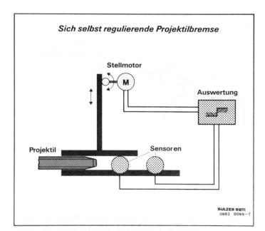
Bild 11 Sich selbst regulierende Projektilbremse
