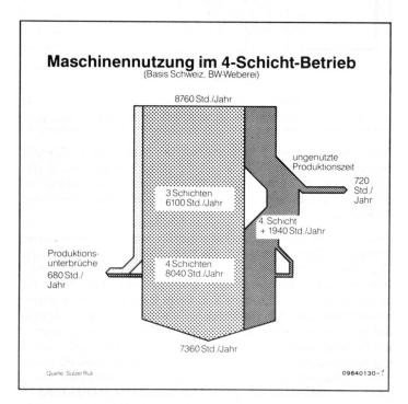
Bild 2 Maschinennutzung im 4-Schicht-Betrieb
