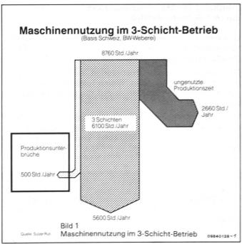
Bild 1 zeigt die im 3-Schicht-Betrieb erreichbare Maschinenlaufzeit: rechts die Verluste durch Begrenzung der Arbeitszeit, links die durch Produktionsunterbrüche bedingten Stillstände während der Anwesenheitszeit des Personals.
