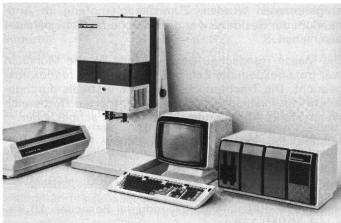
Ein modernes Zweistrahl Gitter-Monochromator-Spektralphotometer und die neuesten Desktop-Computer und Peripherien von Data General sind die Elemente der neuen, kompakten und preisgünstigen Pretema-5000 Farbmess- und Rezeptiersysteme.
