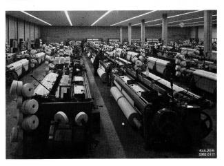
Abb. 3 Sulzer-Webmaschinenanlage der Wisselink's Textielfabrieken BV in Aalten, Niederlande, mit 76 Projektilwebmaschinen. Zur Reinigung seiner Maschinen und Produktionsräume setzt das Unternehmen eine zentrale Sulzer-Vakuum-Reinigungsanlage mit einem Fördervolumen von 2100 m³/h ein.
