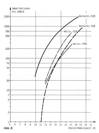
Vergleich von Dickstellen zu Dünnstellen bei kardierter und gekämmter Baumwolle
