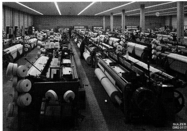
Abb. 3 Sulzer-Webmaschinenanlage der Wisselink's Textielfabrieken BV in Aalten, Niederlande, mit 76 Projektilwebmaschinen. Zur Reinigung seiner Maschinen und Produktionsräume setzt das Unternehmen eine zentrale Sulzer-Vakuum-Reinigungsanlage mit einem Fördervolumen von 2100 m 3 /h ein.
