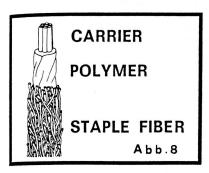
Bei Pavena (von Rieter inzwischen aufgegeben) und Twilo sind die Kleber nach Fertigstellung des Flächengebildes auszuwaschen, beim Bobtexverfahren bleibt der Faden im Originalzustand erhalten, das heisst Filamentträger, polymere Zwischenschicht und Stapelfasern als Aussenschicht.
