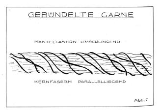
Garn» (Abb. 7). Bekannt sind hier Rotofil (aufgegeben), Dref III, Murata Jet Spinning u.a.m.
