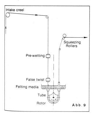
tinuierliche Verfahren ersetzt das bereits bekannt diskontinuierliche Verfahren der Garnverfilzung im Strang und erweitert es auf den Bereich ungedrehter Vorprodukte. Im Teppich- und Möbelstoffsektor erhält man klarere Strukturen im Endprodukt und kann ein unerwünschtes oder unkontrolliertes Nachfilzen vermeiden. Vertrieben wird es wie das Twilo-System von der Firma Hollandse Signaal Apparaten.
