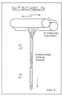
Lässt man einen Faserverband zwischen hin- und hergehenden Nitschelwalzen durchlaufen, so erhält er zwar Drehungen, nämlich alternierend auf kurze Stücke jeweils in Z- und S-Richtung (Abb. 3). Das Rückdrallmoment hebt aber diese Drehungen sofort wieder auf. Lässt man jedoch zwei Faserverbände parallel und dicht
