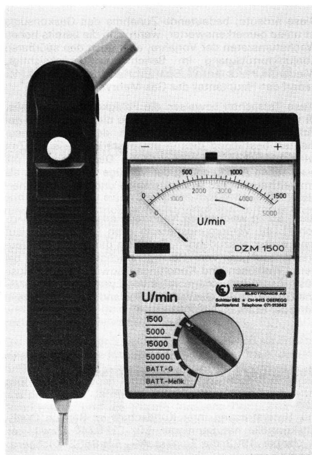
Ein berührungsloses (photoelektrisches) Messprinzip arbeitet in einem Messabstand von ca. 0,5 bis 30 cm zum Messobjekt. Es werden hell-dunkel Unterschiede ausgewertet, sofern diese vorhanden sind, sonst kann z.B. mit einer Kreide, Klebband usw. nachgeholfen werden.
