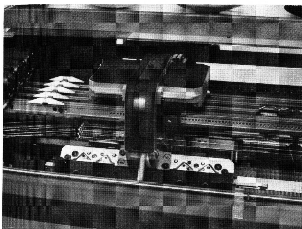
Abb. 7 Der Schlitten der Intarsien-Maschine MC-618
