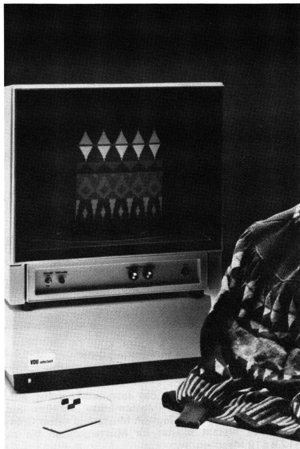
Abb. 3 Farbmonitor mit Mischregler zum Einregeln der Farben
