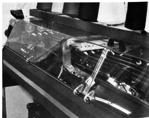
Abb. 10 Der Bewegungsraum des Schlittens ist verkleidet
