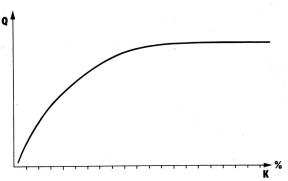
Kämmband-Qualität in Abhängigkeit des Auskämmungsgrades
