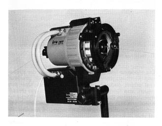
Die AB IRO bringt jetzt einen Schussfadenspeicher mit der Modellbezeichnung IWF-8107 heraus, der direkt an das normale Leitungsnetz der Weberei mit Spannungen von 200...600 V und drei Phasen angeschlossen werden kann. Transformatoren sind nicht mehr erforderlich. Die Liefergeschwindigkeit beträgt bei 50 Hz maximal 1100 m/min, bei 60 Hz bis zu 1250 m/min.
