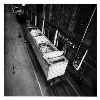
Immer mehr Häfen in Ländern der Dritten Welt sind heute für den Umschlag von Open-Top-Containern eingerichtet. Dies erlaubt zunehmend, den Versand schwerer und sperriger Ladegüter, die früher nur als Einzelsendung mit entsprechend aufwendiger Spezialverpackung verschifft werden konnten, in diesen Containern als kostengünstige Sammelsendung vorzunehmen.
